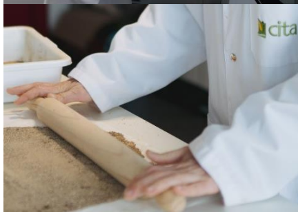
Figura 8. Fotos del procedimiento de trabajo de secado y tamizado de muestras de suelo en el laboratorio del CITate y entrega de muestras al Laboratorio.
