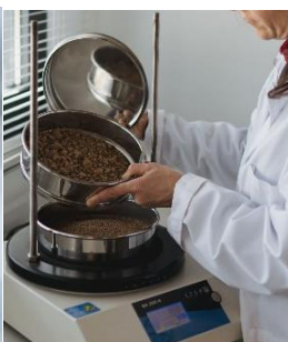
Figura 8. Fotos del procedimiento de trabajo de secado y tamizado de muestras de suelo en el laboratorio del CITate y entrega de muestras al Laboratorio.
