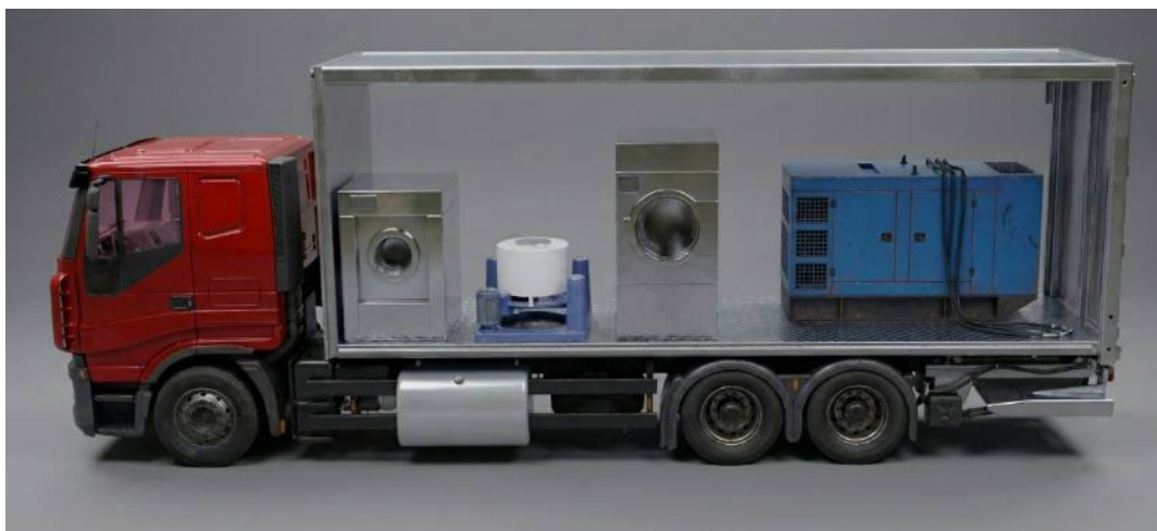
Figura 17. Disposición de los elementos en la caja del camión (lateral izquierdo).
