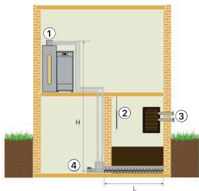
SISTEMA DE CARGA CON SILO ARTESANAL Y SINFIN DE ALIMENTACIÓN
